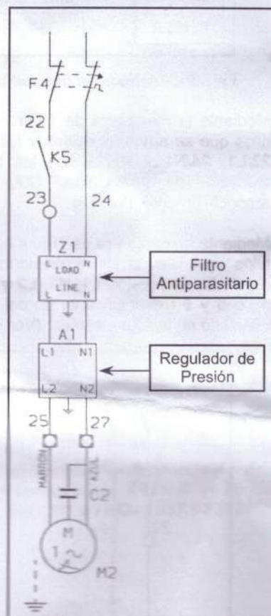
Fig. 25 - Esquema eléctrico de conexonado del Control de Presión de Condensación "P215DP" en las Unidades de frío Modelos "50TA/TZ036-060 y 38TA/FZ036-060".
